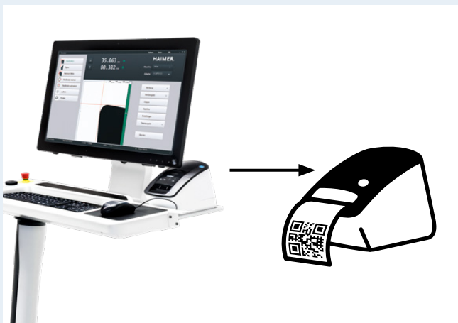
Après l'étalonnage de l'outil, une étiquette avec le code QR est imprimée Dopo aver misurato l'utensile, viene stampata un'etichetta con il codice QR
