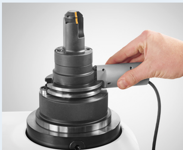
Positionnement manuel de la tête d'écriture/de lecture Posizionamento manuale della testina di scrittura e di lettura
